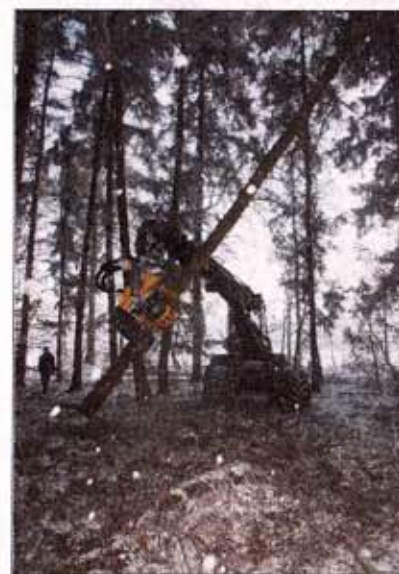
Der Baum ist ab, der Stamm wird entastet, dann erfolgt der Schnitt in Drei-Meter-Stücke.
