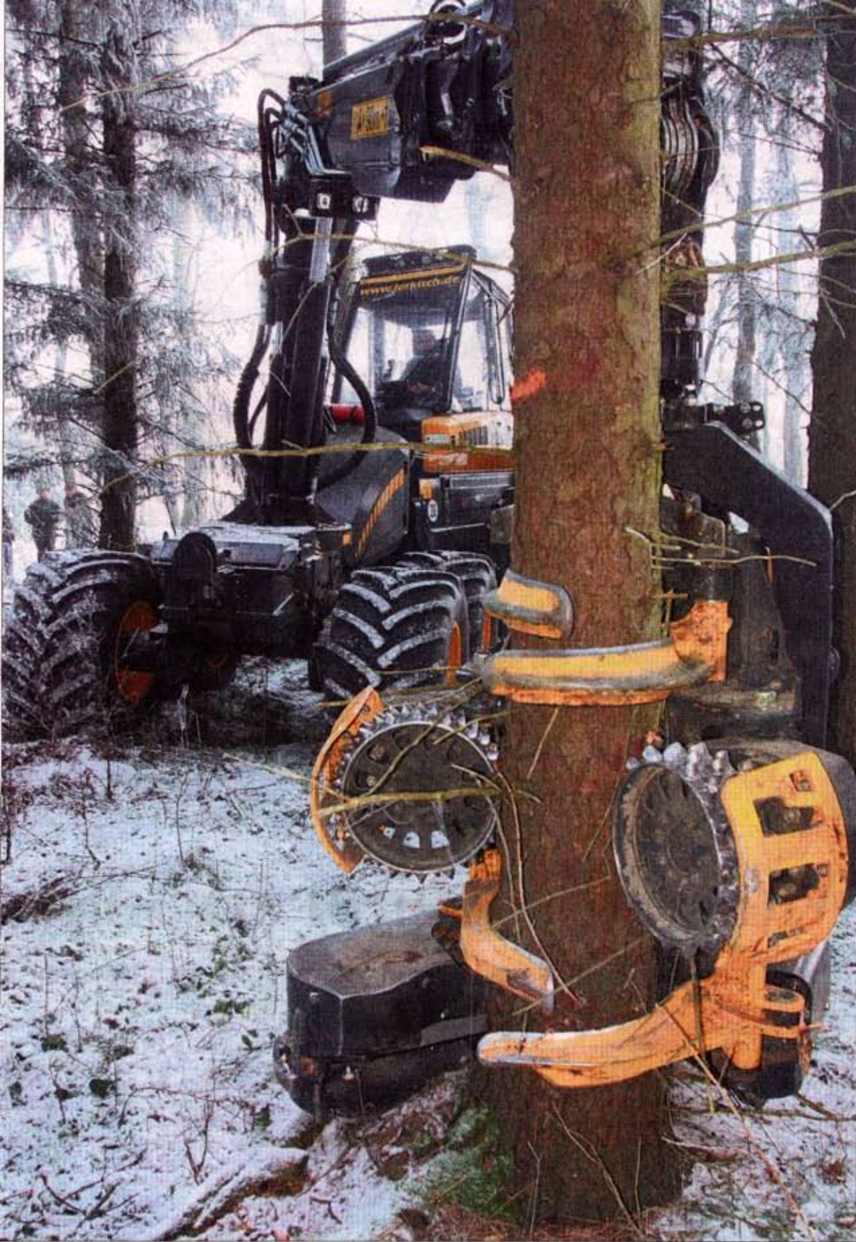
Im Klammergriff: Diese Fichte hat keine Chance mehr. Der „Arm“ des Harvesters hat den Stamm umklammert, gleich klappt unten die Säge aus . . . , dann werden die Äste abgescheuert und der Stamm portioniert.
